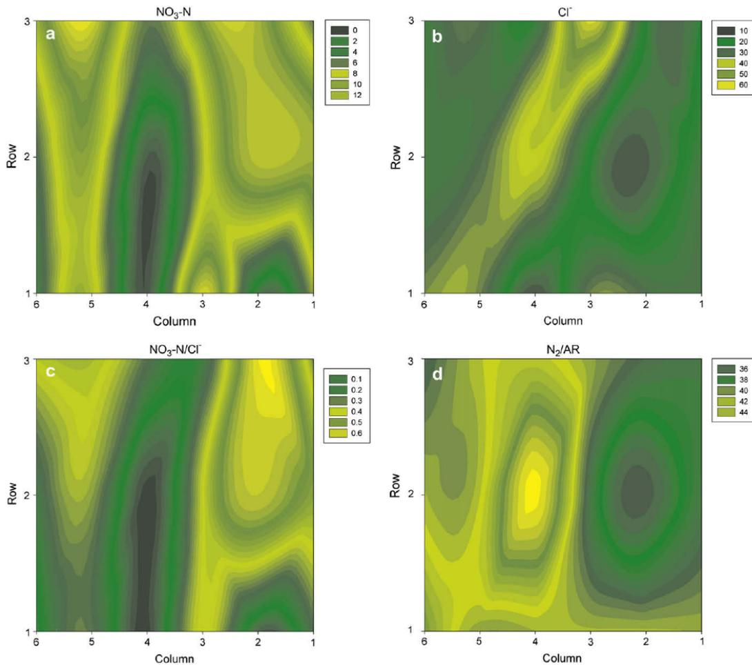
FIGURE 6.5 SPATIAL DISTRIBUTION ACROSS SIX PLOTS (X-AXIS) OF GROUNDWATER A) MEAN NO<sub>3</sub>-N CONCENTRATION B) MEAN CL<sup>-</sup> CONCENTRATION C) MEAN NO<sub>3</sub>-N/CL<sup>-</sup> RATIO AND D) N<sub>2</sub>/AR RATIO ON A RANDOM DATE.
