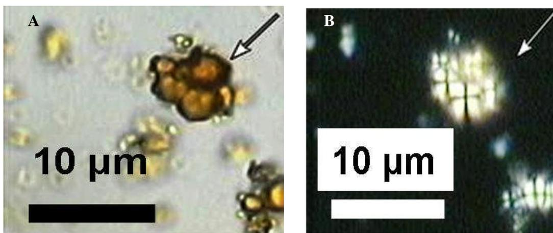
FIGURE 4.3 A) CHARACTERISTIC COLOUR OF OCHRE AS SHOWN BY OOLITIC CRYSTALS IN BRIGHT FIELD AND B) RADIAL CRYSTALLISATION OF THE OOLITE
