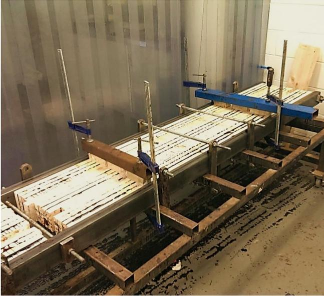
Figure 3. Clamping Rig.
